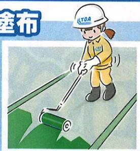
EGカラーを袋ごとよくもみ、よく攪拌してから、容器に移します。ローラバケなどを使ってEGカラーを塗布します。乾燥後、もう一度塗布して仕上げます。
